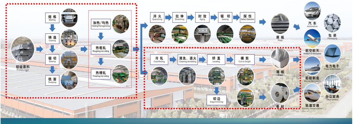
图3-1 铝卷生产工艺流程图（红色虚线内）
